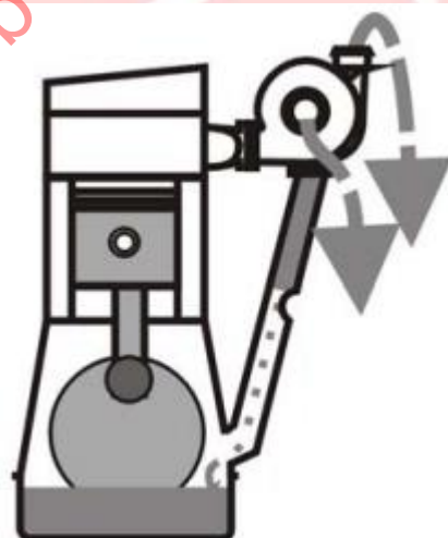
Figura 2. Obstrucción en retorno de aceite.
